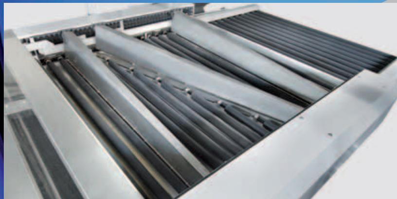
**Zona di lavaggio e soffianti di asciugatura in acciaio inox.**
