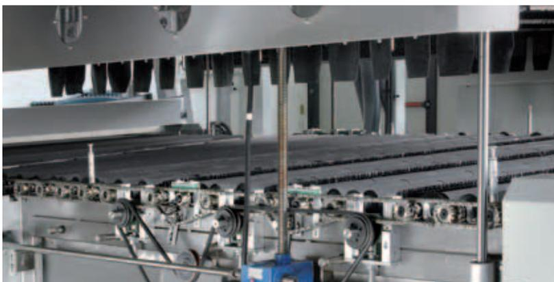
**Sollevamento della macchina fino a 500 mm per facilitare le operazioni di manutenzione e ispezione.**
