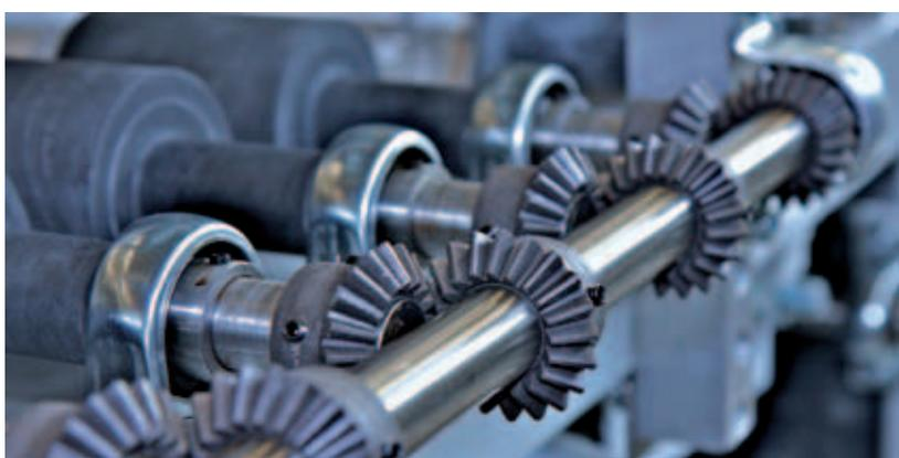
**Trasmissione meccanica in inox con coppie coniche su ogni rullo di trasporto.**
