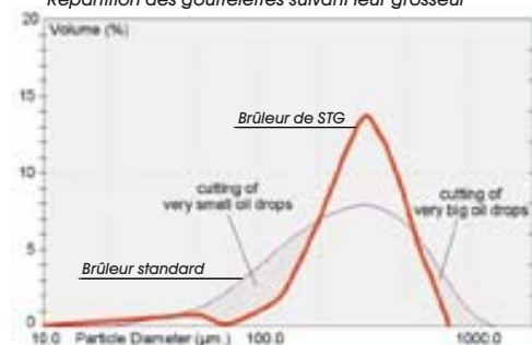
Brûleur à fioul DeNO x : Répartition des gouttelettes suivant leur grosseur
